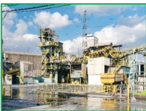
破碎・磁力選別・磨鉱・篩分 スラグ製品の品質作込み
