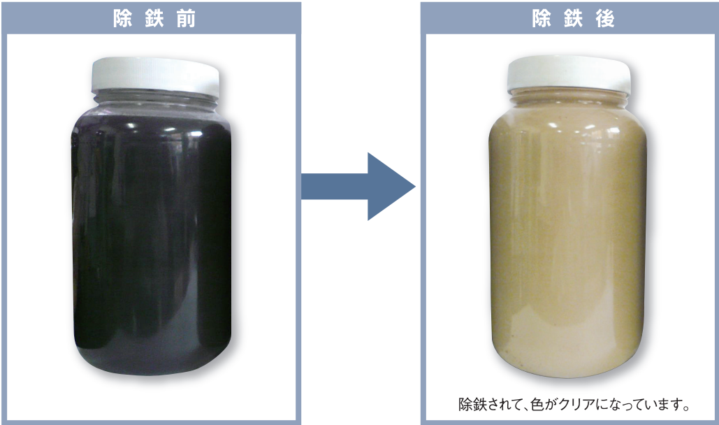
テスト例 処理前の圧延油(元液)と、処理後の圧延油
